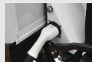
Typ2 Ladekabel eingesteckt
