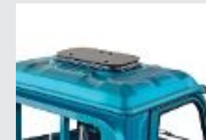
Dach mit Lüftungselement
