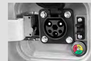
Ladebuchse mit Ladestandsanzeige
