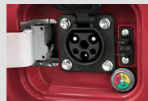
Ladebuchse mit Ladestandsanzeige
